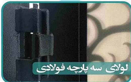
لولای مورد استفاده در درب‌های فلزی لیزری بزرگمهر از نوع سه پارچه با کیفیت بالا می‌باشد که توسط جوش گاز کربنیک به چهارچوب درب متصل می‌شود. لولاهای درب توسط یک تسممه فلزی تقویت می‌گردند تا درب تولید شده نیازی به رگلاژ پس از نصب نداشته باشد. به همین دلیل درب در مقابل فشارها و ضربات ناگهانی از مقاومت بالای برخوردار است. همچنین با توجه به نوع لولا و نحوه اتصال آن عمر مفید درب بسیار افزایش می‌باید.
