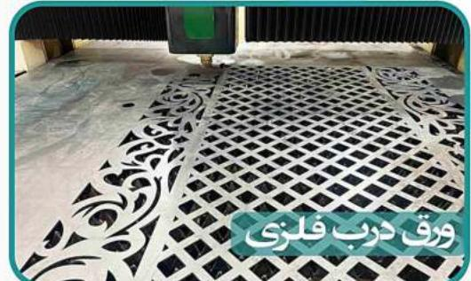
تمامی درب‌های بزرگمهر از ورقه‌های فولادی با استاندارد ST37 شرکت Din کشور آلمان و با ضخامت ۳ میلی‌متر ساخته می‌شوند که با توجه به میزان کربن پایین اینگونه ورقه‌ها، از جوش پذیری مناسبی برخوردار می‌باشند. همچنین در تولید این درب‌ها، از ورقه‌های یکپارچه فولادی استفاده می‌شود تا ضمن تکمیل زیبایی، استحکام درب نیز افزایش یابد.
