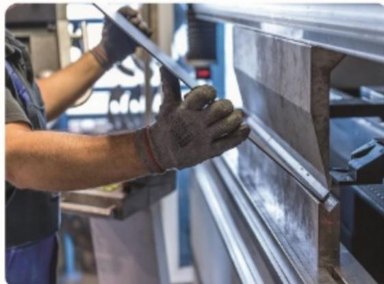
در عملیات خمکاری، با اعمال نیرو به ورق های فلزی، توسط دستگاه های پیشرفته، ورق ها زاویه دار شده و همراه با پروفیل های نورد شده و قطعات فرورزه به واحد جوشکاری و تولید ارسال می گردد.
