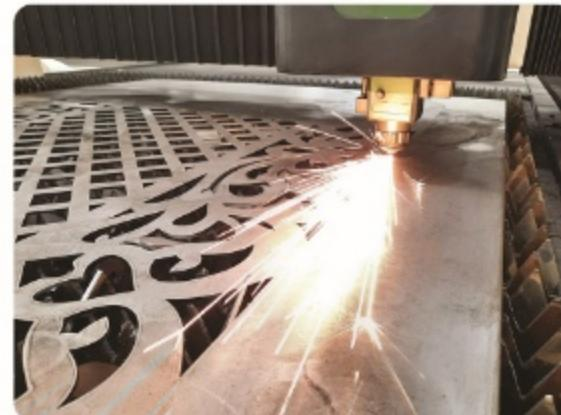
همچنین پروفیل های مورد نیاز ساخت درب، توسط دستگاه های برش لیزری پروفیل، برش و سوراخ کاری می گردد تا دقت ساخت و کیفیت محصول نهایی دو چندان شود.
